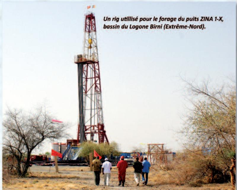
Un rig utilisé pour le forage du puits ZINA 1-X, bassin du Logone Birni (Extrême-Nord).
